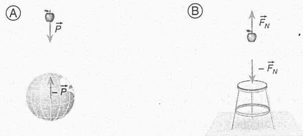
Figura 3.40 Reações das forças que agem na maçã: (A) -\vec{P} e (B) -\vec{F}_N .
